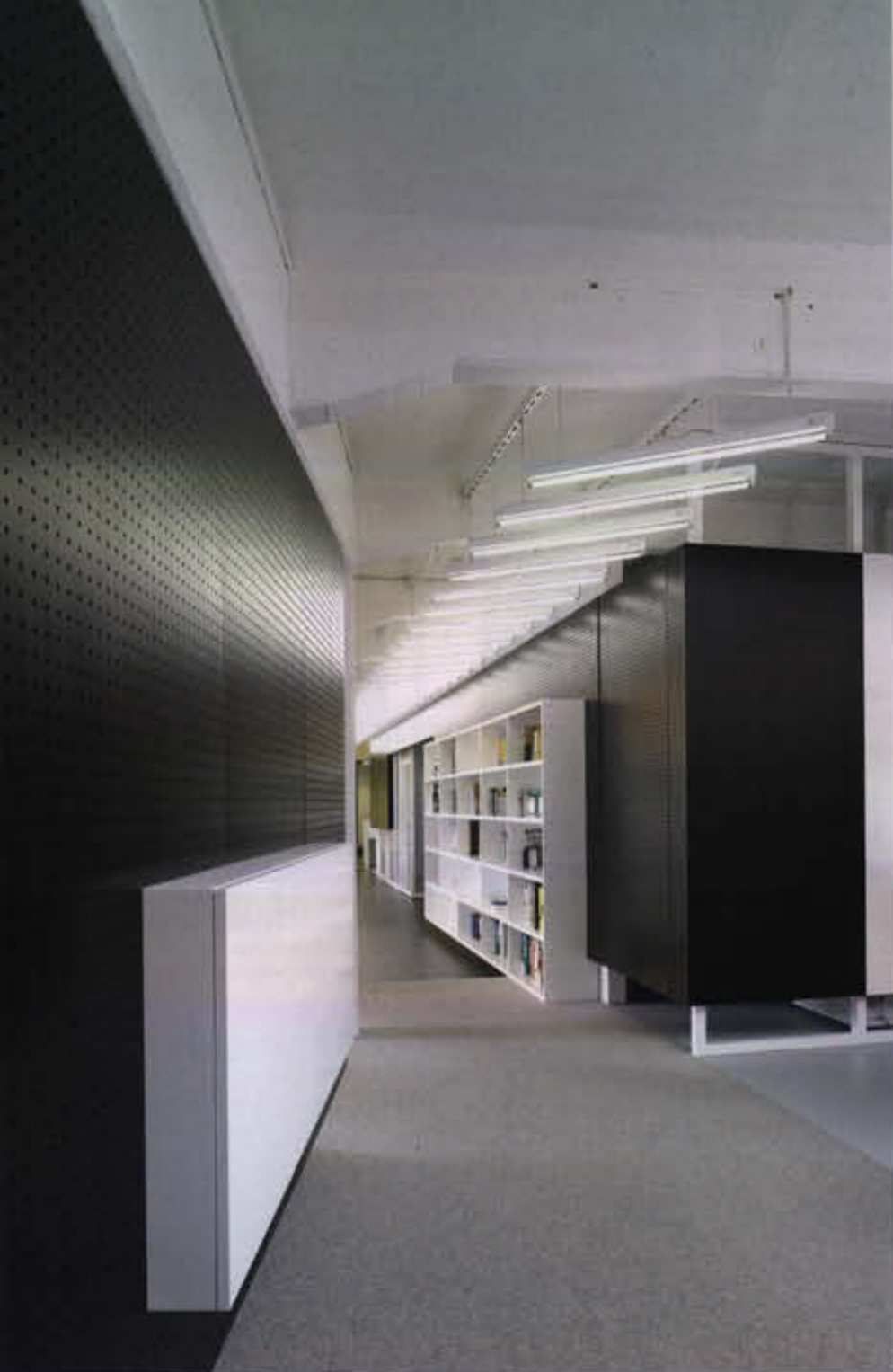
4 Eine Fassade aus dunkelbraun gebeizter MDF nimmt die offenen Elemente der Bibliothek auf. Durch die Transparenz der Einbauten bleibt der Raumfluss erhalten
