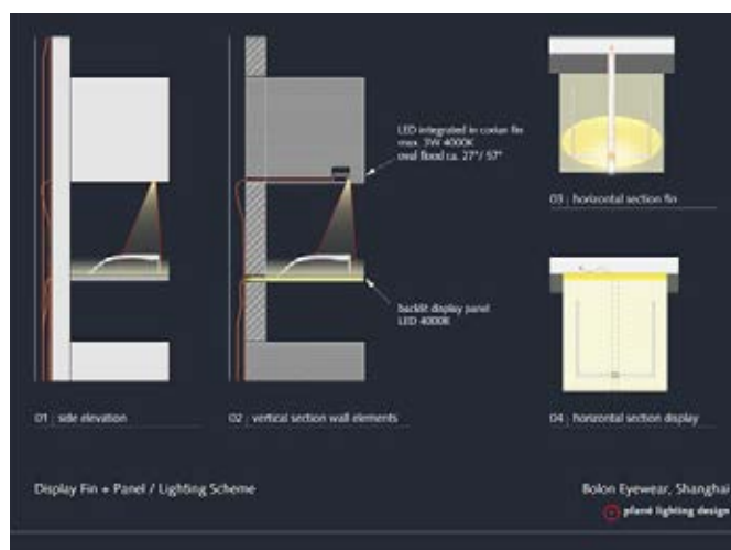
El esquema muestra la iluminación de los paneles expositores mediante una tira LED en la parte trasera y un Spot LED que proyecta una intensa luz sobre las monturas expuestas.
